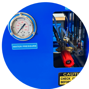
Regulacja ciśnienia strumienia wody procesowej
